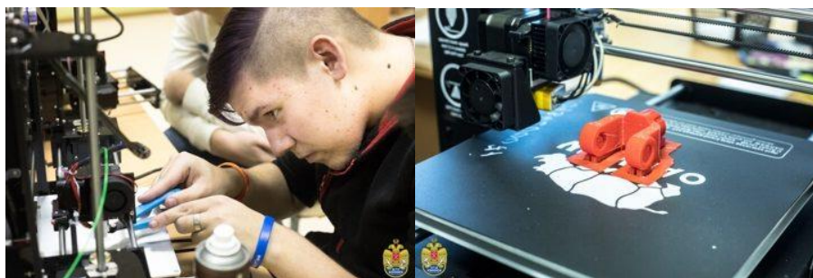
Рисунок 2. Подготовка 3D-принтера (слева) и печать изделия (справа)
