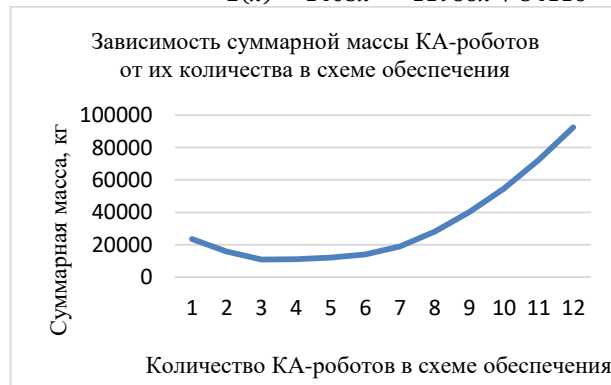
Рисунок 6 – Зависимость суммарной массы обслуживающих КА-роботов от их количества в схеме обеспечения
